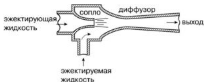
Рисунок 13 – Обобщенная схема эжектора
